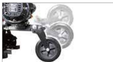
Переднее колесо, полезное при транспортировке машины, можно приподнять для большего удобства вспашки.
