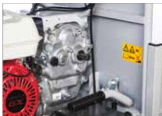
Независимый отбор мощности при 2100 об/мин.
