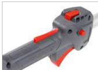
Выключатель "AlwaysOn": быстродействующий при выключении, и с автоматическим возвратом для постоянной готовности к работе.
