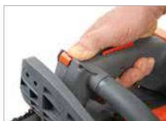
Выключатель "AlwaysOn": обеспечивает быстрое выключение, а благодаря его автоматическому возврату в исходное положение машина всегда готова к работе.
