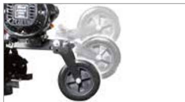
La ruota di trasferimento anteriore, utile per il trasporto della macchina, può essere rialzata per agevolare il lavoro sul terreno.
