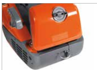
Gancio per moschettone: ripiegabile ed in acciaio è pensato per un aggancio rapido della macchina all'operatore.
