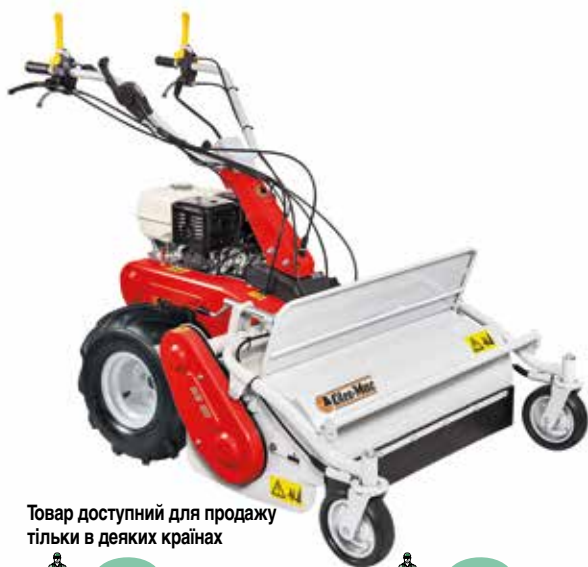
Незалежні поворотні муфти керма на ведучих колесах, оснащених функцією блокування, дозволяють машині надзвичайно легко маневрувати.
