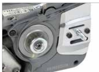
Зчеплення OnBoard: швидко установка ріжучого елемента, мінімальне забруднення муфти зчеплення, що забезпечує незмінні з часом характеристики.
