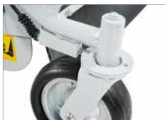
Передні поворотні колеса можуть блокуватися оператором.
