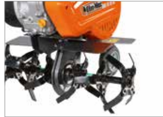
Фреза з 3-х елементів із кожного боку по 46 см. стискається до 32–22 см.
