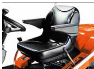
Регульоване сидіння з підлокітниками дає змогу підлаштуватися під потреби користувача, забезпечуючи комфортну роботу упродовж кількох годин.
