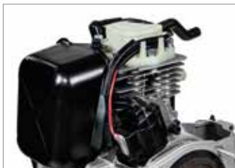
4-тактний двигун з верхнім розташуванням клапанів (OHV).
