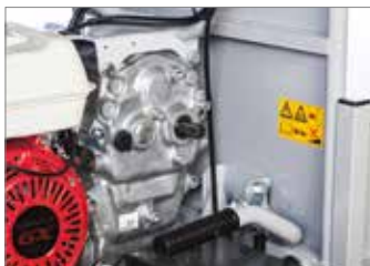
Незалежний відбір потужності під час 2100 об/хв.
