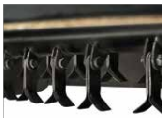
Ротор з Y-подібними потужними та міцними ножами дозволяє ефективно подрібнювати траву або гілки, не побоюючись ударів та ушкоджень.
